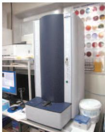
NHO 初となる最新型の質量分析計を細菌検査室に導入しました。国内では2台目となります。レーザーでイオン化された試料は、電圧をかけることで加速され、検出器までの到達時間から得られたマスペクトルによって菌種を同定します。前処理時間を含めて10分程で菌種の同定が可能です。
