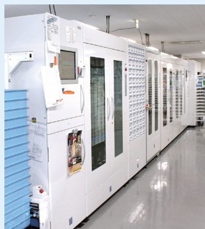
薬剤部 注射薬自動払い出しシステム (注射薬ピッキングマシン)
