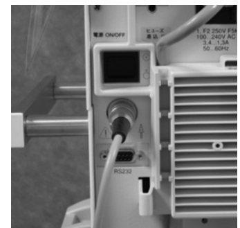
（図2）連動ケーブルをナースコールハンドスイッチ、人工呼吸器へ接続したところ
