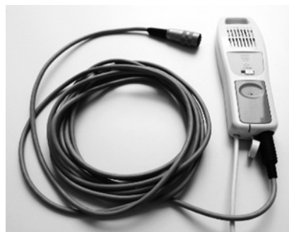
（図2）連動ケーブルをナースコールハンドスイッチ、人工呼吸器へ接続したところ
